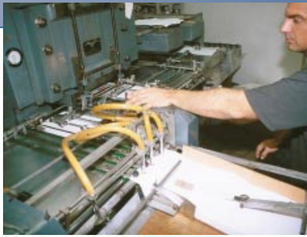
Mit der automatischen Prägepresse werden größere Auflagen ausgeführt.
