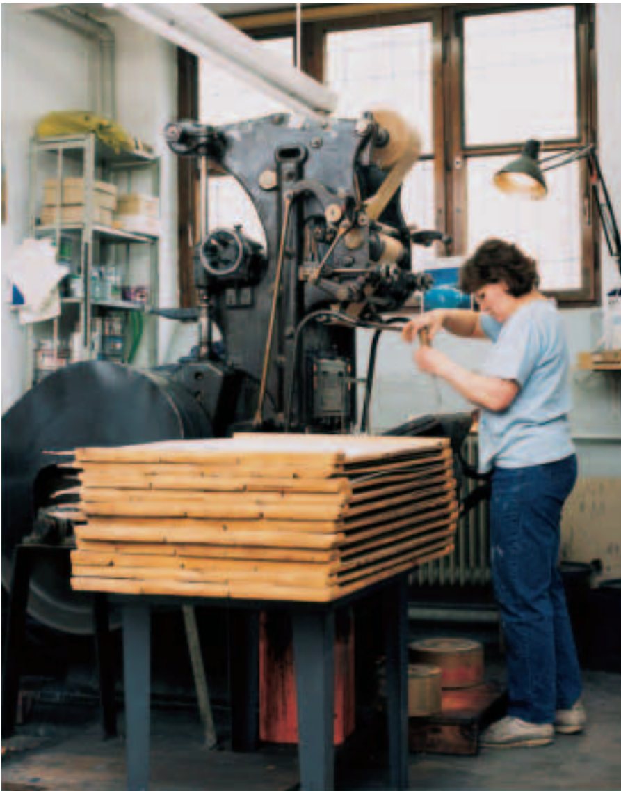
Die älteste von drei Prägedruckmaschinen bei „Hannovera“: Die Bögen werden von Hand eingelegt und zwischen den Stahlplatten (unten) und den so genannten „Patrizen“ bedruckt und geprägt. Das Ergebnis: Der Druck erscheint als Relief.
