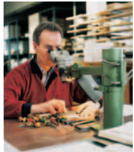
Der Graveur: Die Anfertigung der Stahlplatte erfordert mikroskopisch feinste Handarbeit.
