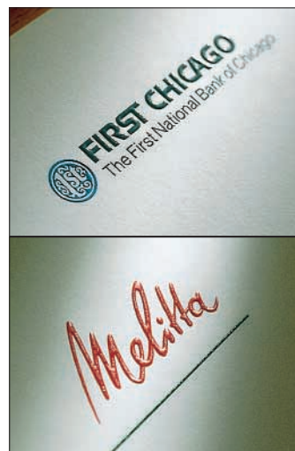
Nuancierte Farbgebungen sind ein mögliches Charakteristikum des Stahlstichs. Spezielle Lacke geben dem Druckbild Tiefe und Lebendigkeit sowie ein leuchtstarke Anmutung.
