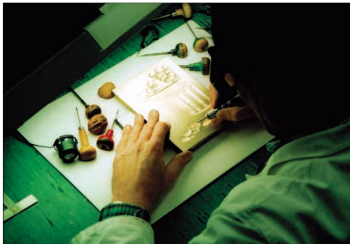
Stahlstich-Druckformen werden von Graveuren in Handarbeit hergestellt. Die freihändige Arbeit mit Lupe und Stichel ist Kunsthandwerk reinsten Wassers.
