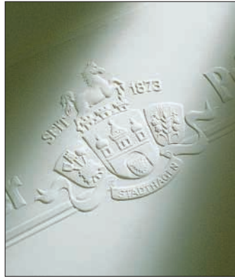
Eine reizvolle Ergänzung des Stahlstichdrucks ist die Blindprägung.
